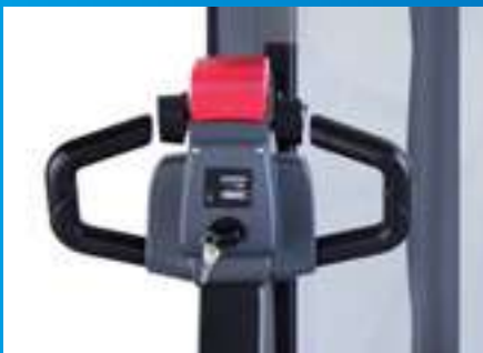
Ergonomischer Deichselkopf mit Batterie- und Betriebsstundenanzeige
