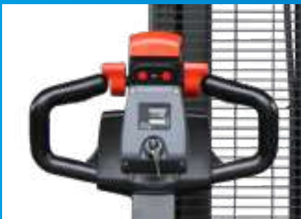
Ergonomischer Deichselkopf mit integriertem Schlüsselschalter
